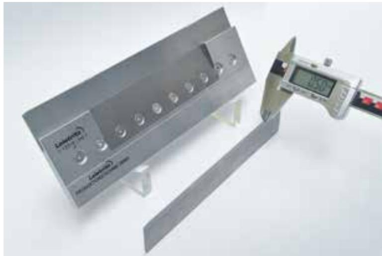
Hartmetalleinsätze mit 2 mm Grundstärke werden entsprechend der zu schleifenden Werkstücke im A-Maß (Hartmetall-Auflagestärke) angeschliffen. In diesem Beispiel sind es 0,5 mm. Kundenseitig können verschiedene Einsätze bevorratet und gewechselt werden.
